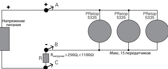
Выходы до 15 модулей можно соединить параллельно для дискретного обмена данными по протоколу HART® в двухпроводном подключении.
