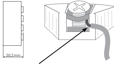
Провод монтируют между пластинами
